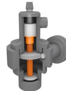
dryspin® Gewindetechnik im Druckspeicher für elektronische Bremskraftverstärker
