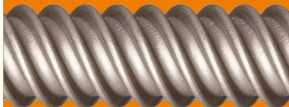
Ein Linksgewinde steigt von rechts unten nach links oben. Eine alternative Bezeichnung dafür ist linkssteigendes Gewinde. Linksgewinde werden in Fertigungszeichnungen meist mit den Buchstaben LH gekennzeichnet, z. B. TR20x4-LH.
