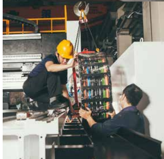
Als komplett vorkonfektionierte readychains® werden die Energieketten inklusive Leitungen und Montagegestell bei Hartford angeliefert.
