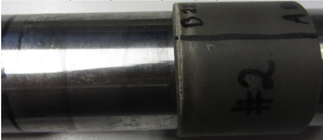
Bild 2: gelaufenes iglidur® TX1 Lager mit zugehöriger Welle (Beispiel)
