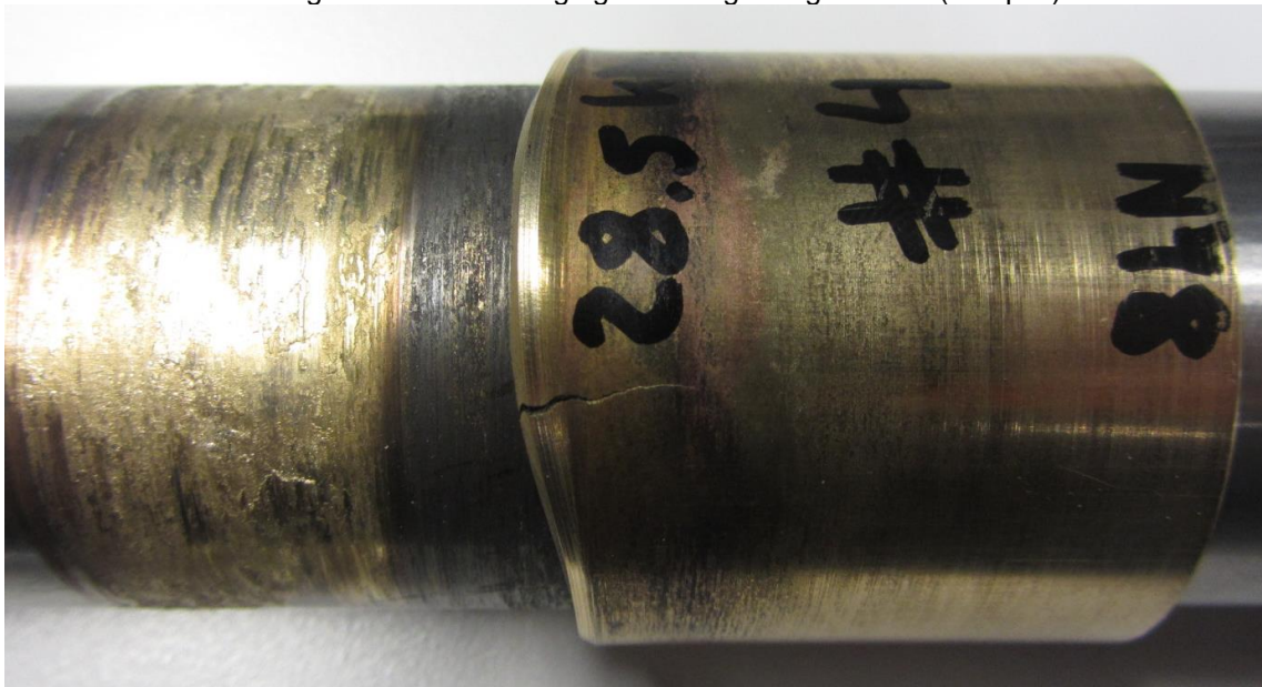
Bild 3: gelaufenes Messinglager mit zugehöriger Welle (Beispiel)
