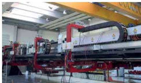
Um die Verfahrwege von 12 m realisieren zu können, wurde in diesem Vakuumbandstapler E4 e-ketten® mit dem guidelok System verwendet. igus® E4 e-chains® with the guidelok system have been used in this vacuum-belt lift truck.
