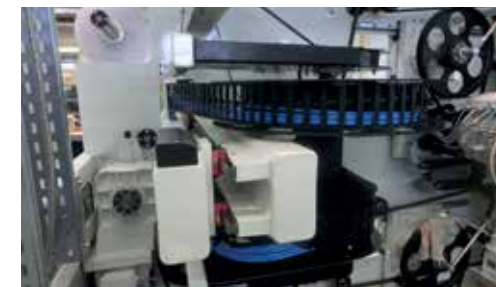
Dank der liegend eingebauten e-spool von igus® kamen die Konstrukteure hier mit dem Bauraum problemlos zu recht. Thanks to the side-mounted igus® e-spool, the designers had no problems with the installation space here.
