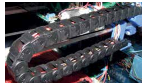
In dieser CNC-Hybrid-Maschine können Werkstücke in verschiedenen Verfahren bearbeitet werden. Materials can be processed in several procedures in this CNC hybrid machine, which uses a miniature e-chain®.
