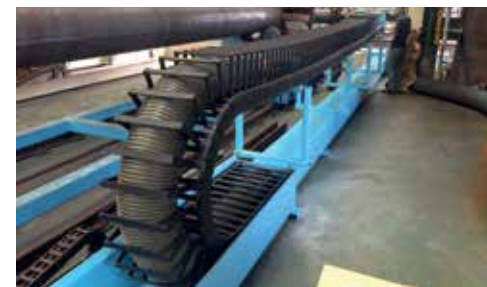
Dieser Schlauch wird über fast 10 m verfahren und mit einer igus®-Bügelkette geführt. This hose is moved over almost 10 m and guided by an igus® e-chain® with extend cross bars.
