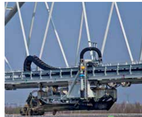
Serie E4.350 in einer Schlickaufbereitungsanlage. 100 kg/m schwere Schläuche werden sicher auf 150 m geführt Series E4.350 in a mud treatment plant. 100 kg/m heavy hoses are guided reliably to 150 m.
