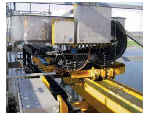
e-ketten® in ESD-Ausführung sind z.B. auf Ölplattformen erforderlich ESD e-chains® are required for example on oil platforms.
