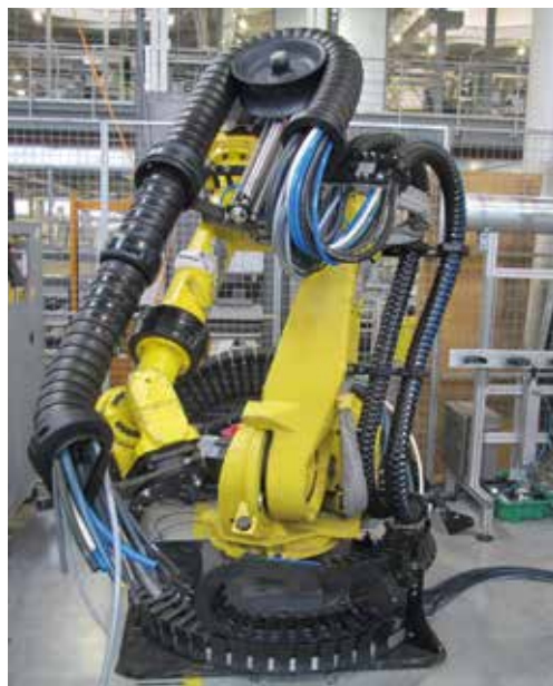
Test für kombinierte Bewegungen: Simulation von komplexen Bewegungen in Roboteranwendungen
