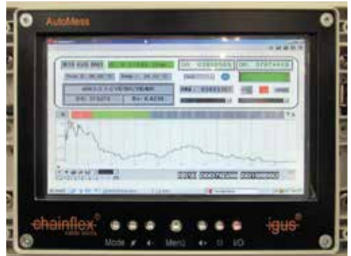
Auswertung der Messdaten: igus® "AutΩMeS" System
