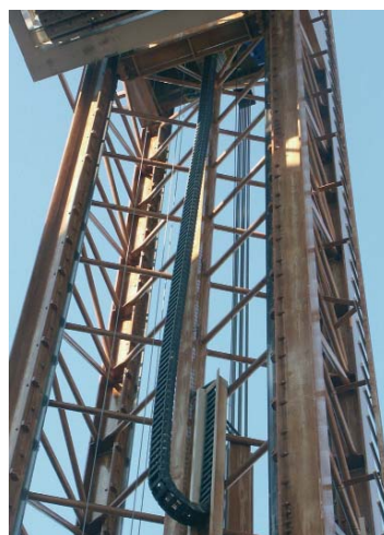
Bild FA0906-08: igus GmbH, Köln Durch einen Führungskanal wird das "ReadyChain"-System zusätzlich stabilisiert.
