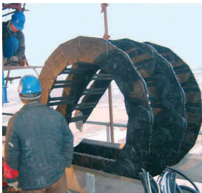
スチール製ガイドチャンネルへE4シリーズ800型のア センブリー中
