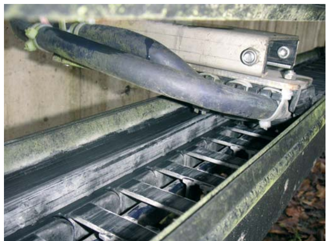
Bild FA0206-06: igus GmbH, Köln Auf der ins Profil integrierten Gleitschiene des LBT Flizz-Systems läuft die igus-Energiekette mit minimaler Reibung.
