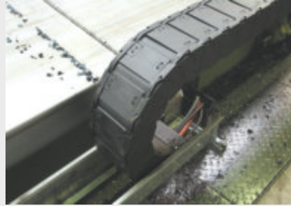
Portalfräsmaschine mit E4 E-Rohr aus igumid HT, an dem Späne bis 850° problemlos abprallen
