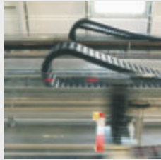
Zug-Schubkräfte Geschwindig- keit bis 10 m/s, Beschleunigun- gen bis 200 m/s 2 werden getestet
