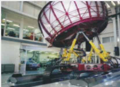
Fahrsimulator mit igus® E-KettenSystem® E4: Hydraulikschläuche wiegen über 60 kg/m
