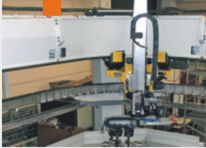
System E4 E-Kette® im Kurvenbereich (90°-Kurve) mit ca. 45 m langem Verfahrensweg
