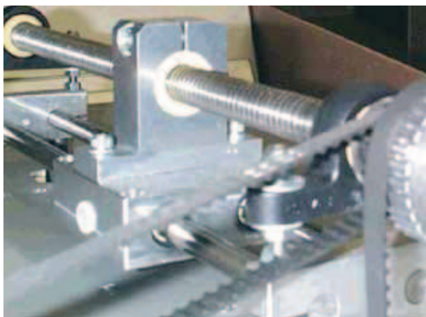
Les écrous pour vis trapézoïdales iglidur® constituent le complément idéal des guidages linéaires sans entretien DryLin®
