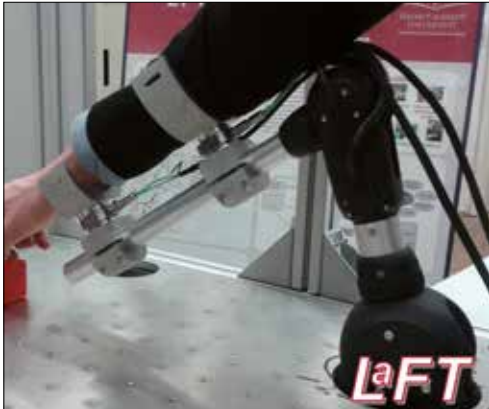
Unterstützungssystem mit Mensch-Technik-Schnittstelle für die Produktion des Laboratorium. [Fertigungstechnik (LaFT), Helmut-Schmidt-Universität, Hamburg] Manual workstation support system with human-machine-interface for the production of the manufacturing technology lab (LaFT) at Helmut-Schmidt-Universität, Hamburg
