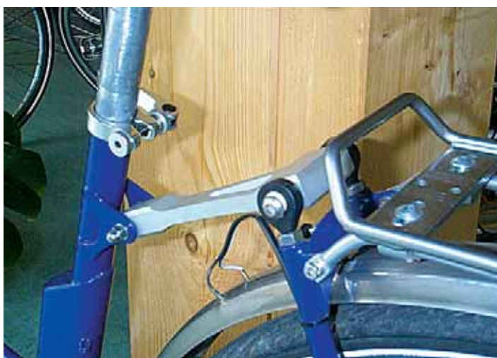
Bild 51.2: igubal®-Gelenkköpfe in der gefederten Hinterradschwinge eines Fahrrades
