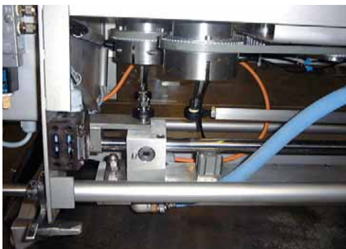
Bild 51.1: igubal®-Gelenkköpfe in einer Pralinengarnieranlage
