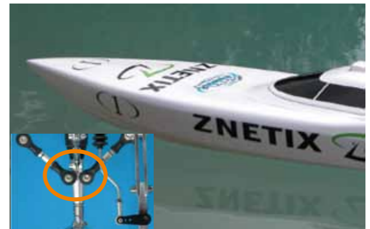
igubal®-Gelenkköpfe zur Stabilisierung und Ausrichtung der Antriebswelle igubal® rod end bearings to stabilize and align the drive shaft
