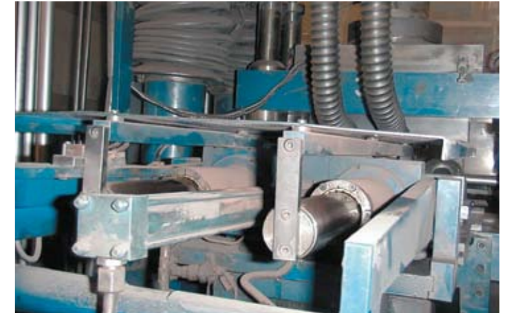
Wartung nur alle 2 Jahre: DryLin® R-Lineargleitlager im Füllschuh-Mechanismus einer Presse Maintenance even after 2 years: DryLin® R linear bearing in filling-shoe mechanism of a comaction unit
