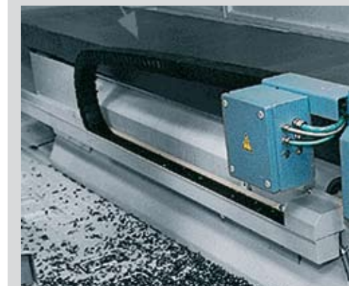
E2 E-Rohr in Werkzeugmaschine mit heißen Spänen E2 E-Tube in machine tool with hot chips
