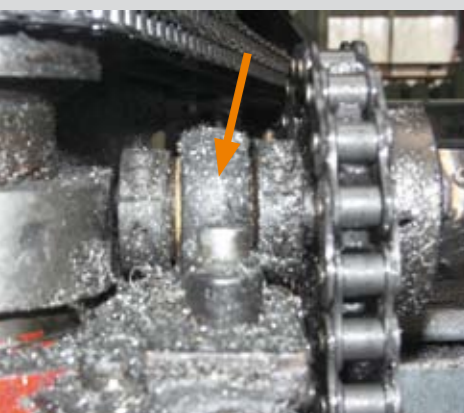
Metallspäne, Öl, Staub: Wartungs- freies igubal®-Stehlager in einer Verschachtelmaschine Swarfs, oil and dust: Maintenance-free igu- bal® pillow block bearing in a inter- lacing machine
