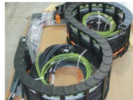
Montageoptimierte Anlieferung Assembly-optimized delivery
