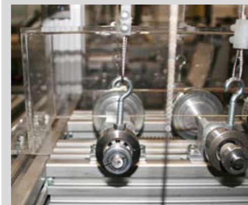
Kugellagertest im igus®-Gleitlager- labor Tests of ball bearings in igus® lab
