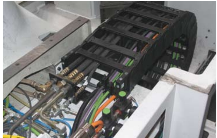
Vorkonfektionierte Energiezuführungen mit integrierter Zugentlastung im Bearbeitungszentrum Pre-harnessed energy chain with integrated strain relief in machine centre
