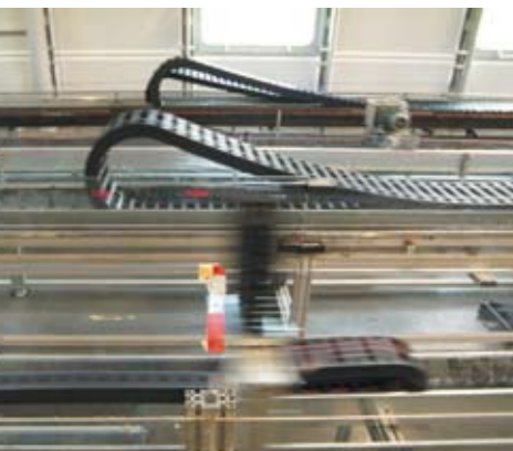
Zug-Schubkräfte Geschwindigkeit bis 10 m/s, Beschleunigungen bis 200 m/s² werden getestet Push Pull forces speed up to 10 m/s, acceleration up to 200 m/s² are tested
