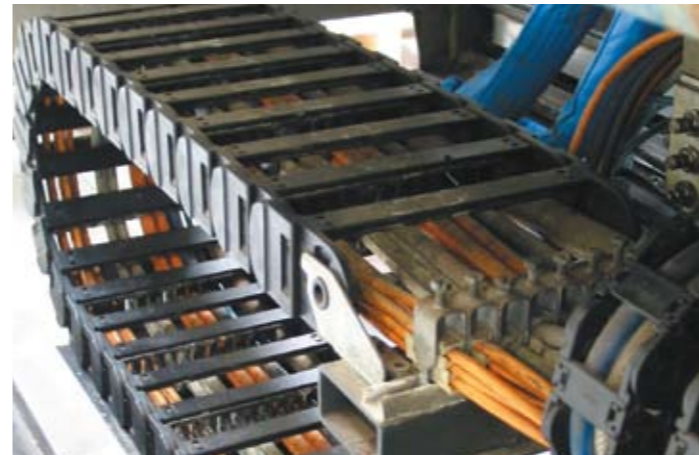
Topzustand auch nach 9 Jahren: E-Kette® in einer hoch präzisen Dreh- und Schleifmaschine E-Chain® in a high precision turning and grinding machine
