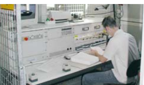
Rechnergestützte Hochspannungsprüfplätze sorgen bei igus® für geprüfte Qualität Computer aided high voltage test stations ensure aided quality at igus®
