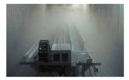
Kältetest bei -40°C von chainflex®-Leitungen und e-ketten®.
