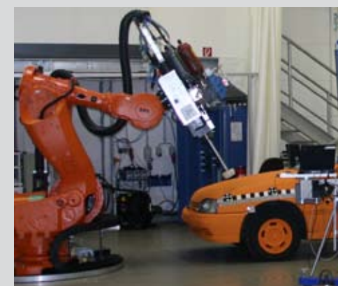
Hohe Beschleunigungen auf 5 km/h in nur 0,03s mit konfektionierter Triflex® R High accelerations up to 5 km/h in only 0,03 sec. with Triflex® R
