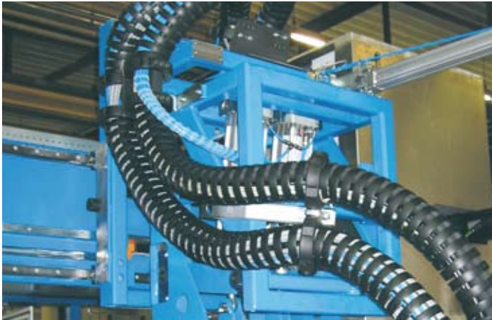
Bewegungen um mehrere Achsen mit igus® Triflex® R light (TRL) Moving about several axes with igus® Triflex® R light (TRL)
