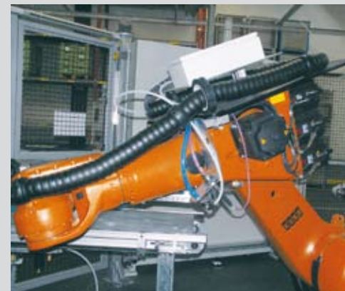
Triflex® R-Set mit zusätzlicher Befestigungsmöglichkeit für Verteilerkästen Triflex® R-Set with additional mounting option for terminal boxes
