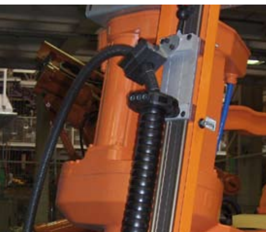
DryLin® W als Rückzugssystem in einem Industrieroboter DryLin® W as a retraction system in an industrial robot
