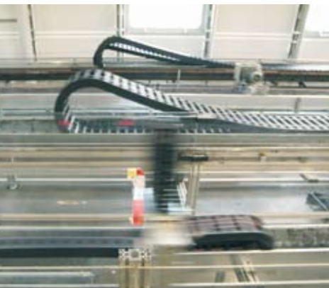
Zug-Schubkräfte Geschwindigkeit bis 10 m/s, Beschleunigungen bis 200 m/s 2 werden getestet Push Pull forces speed up to 10 m/s, acceleration up to 200 m/s 2 are tested
