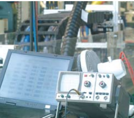
Torsionsprüfungen für Chainflex®-Leitungen und Triflex® R Torsion test-set for Chainflex®-cables and Triflex® R
