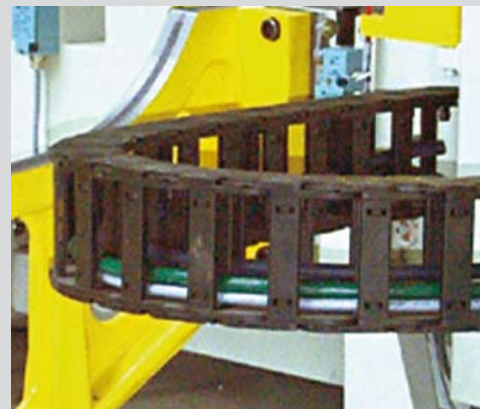
Freitragende Anwendung "auf der Seite" - erhöhte Stabilität durch Hintergriff Unsupported application "side-mounted" - high stiffening for shear forces thanks to tongue and groove design
