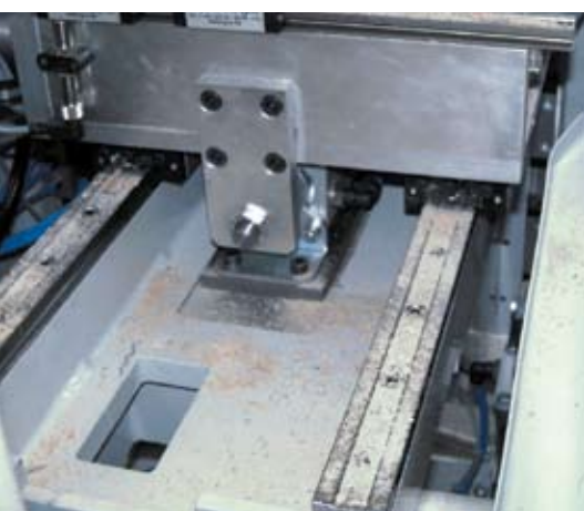
Schmiermittelfreie, schmutzunempfindliche Linearführung mit DryLin® T Lubrication-free and dirt resistant linear guides DryLin® T
