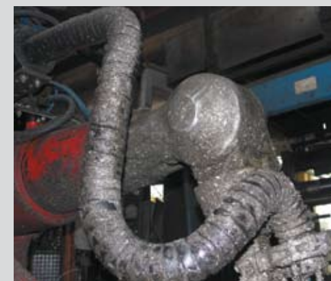
Ausfallsichere Lösung mit Triflex® R auch in stark verschmutzten Umgebungen Fail-safe solution with Triflex® R in harsh environments
