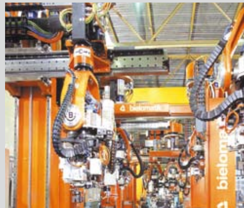
igus® Triflex® und E2 E-Ketten® in einer Fertigungsstraße igus® Triflex® and the E2 System in plastic processing machines
