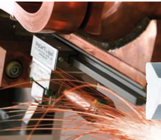
Schweißspritzern und -staub trotz der DryLin® T Lineargleitführungen DryLin® T defies hot chips and dust
