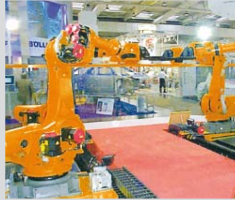
igus® E-Ketten® an der Verfahrachse (7. Achse) für 6-Achsenroboter E-Chain® used for travel axles for 6-axis robots
