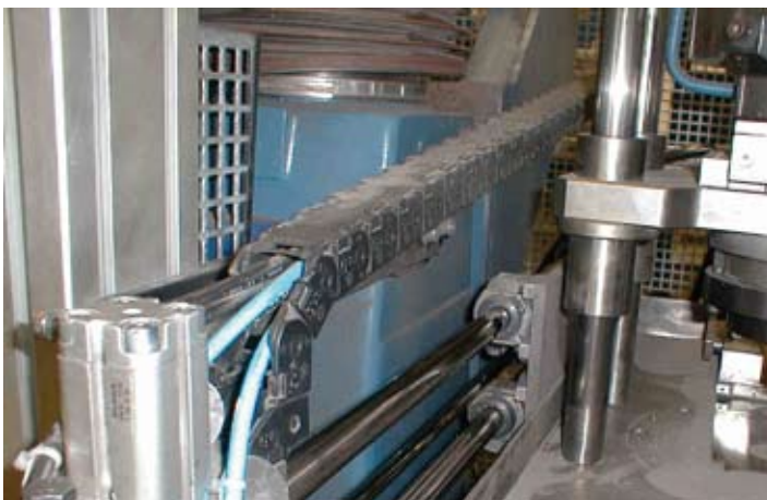
Zipper E-Kette® und schmierfreies DryLin® R Lineargleitlager in einer Sinteranlage Zipper E-Chains® and lubrication-free DryLin® R linear guides in a sinter plant
