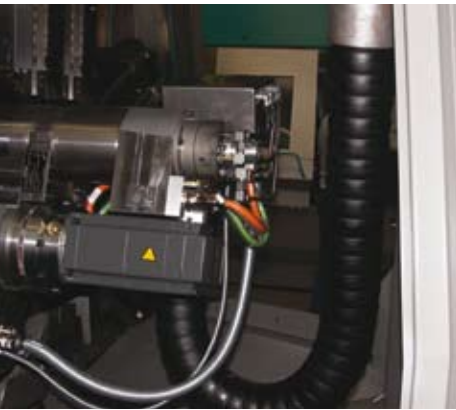
Vorkonfektionierte Triflex® Energiezuführung in einer mehrspindligen Drehmaschine Pre-harnessed Triflex® R in a lathe spindle
