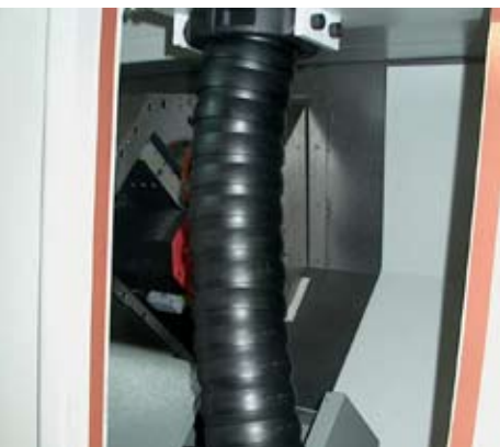
Triflex® R in der geschlossenen Version für optimalen Späneschutz und 3D-Bewegung Triflex® R as closed version for optimal chip protection and 3D movement
