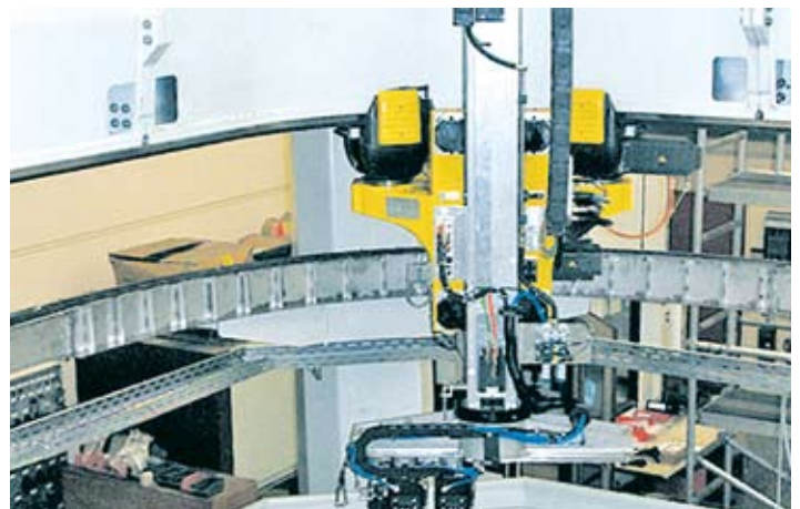
E4/4 E-Kette® im Kurvenbereich mit 45 m Verfahrensweg E4/4 E-Chain® used in curved section with 45 m travel lengths
