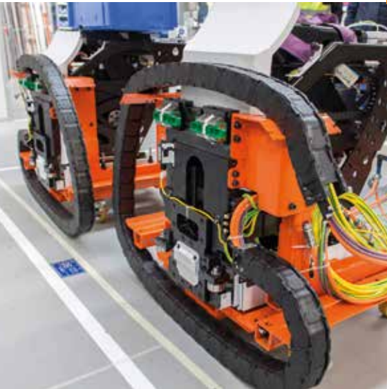
Abb. oben: Zur Versorgung der Biegehilfe einer Biegemaschine kommen R4.1L e-rohre zum Einsatz zur Führung von Motor-, Geber- und Sensorleitungen sowie ein Erdungskabel
