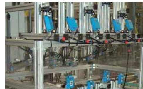
Schwenk-Verschleißtest, um das Verschleißverhalten von iglidur® unter Belastung zu ermitteln
