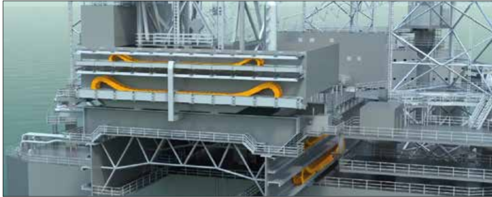
Rig Skidding-Konzept mit einer E4.350 e-kette® für große Schläuche und Leitungen. Kleinere Leitungen können beispielsweise mit e-ketten® der Serien E4.162 und E4.112 geführt werden.
