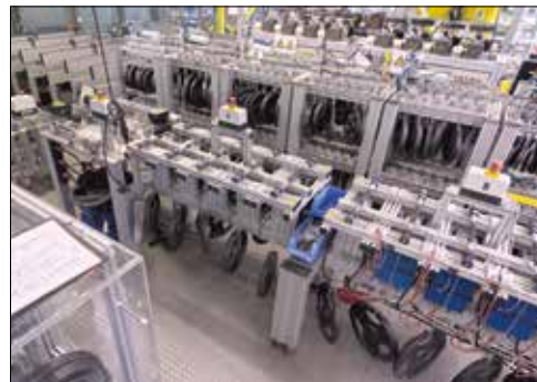
Tribologische Prüfungen im Gleitlagerlabor, igus® Köln.
