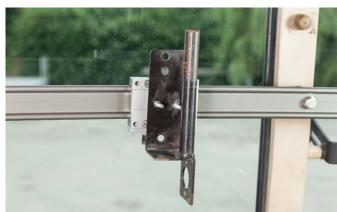
Die sehr verbreiteten Rechnerhalterungen aus Rundrohr (Grundkonsolen) sind vielfach schon vorhanden. Mit zwei Schräubchen können sie direkt auf den Schlitten geschraubt werden. Eine Anschweißplatte aus Stahl muss dann nicht extra angefertigt werden. Verwenden Sie dann aber Senkkopfschrauben, die nicht zu weit nach innen überstehen.
