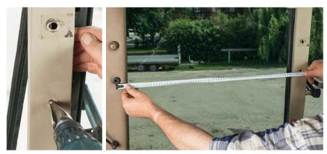
Die Schlepperhersteller haben in aller Regel Befestigungspunkte für die nachträgliche Befestigung von Rechnern etc. an den Kabinenholmen vorbereitet. Das sind Innengewinde-Buchsen, die in die Kabinenholme eingeschweißt sind. Oftmals befinden sich über diesen Stellen Kunststoffstopfen in der Kabinenverkleidung, die dann nur herausgehebelt werden müssen. Ist das nicht der Fall, müssen Sie die Punkte genau heraussuchen und vorsichtig aufbohren. Am besten gelingt das mit einem konischen Schälbohrer.
