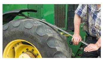
Gebogene Schienen können Sie bestellen oder Sie biegen sie selber nach. Das Zusammenspiel Schiene und Schlitten kann nur dann harmonisch funktionieren, wenn die eloxierte Oberfläche der Schiene absolut beschädigungsfrei ist. Relativ gut kriegt man das hin, wenn man die Schiene über ein Rad biegt. Den passenden Radius findet man rasch, und das weiche Reifengummi verursacht keine Schäden an der Schiene.
