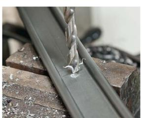
Beim Anpassen der Schiene ist darauf zu achten, dass die eloxierte Oberfläche nicht beschädigt wird, damit der Schlitten ungehindert verschoben werden kann. Geben Sie der Schiene die maximale Länge und durchbohren Sie sie dann an den passenden Stellen.
