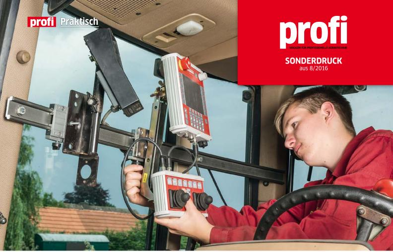
Auf der Schiene können die Rechner ideal positioniert werden. Werden sie nicht gebraucht, verschiebt man sie ganz aus dem Blickfeld.
