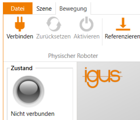
Abbildung 5: Schaltflächen für die Verbindung mit der Hardware, das Zurücksetzen von Fehlern und die Aktivierung der Motoren, die Referenzierung und "Status"-Anzeige.
