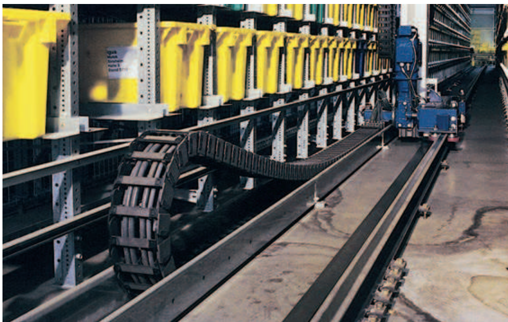
igus® Führungsrinnen aus Stahl im Einsatz eines Regalbediengeräts - Serie E2/000 und chainflex®- Leitungen
